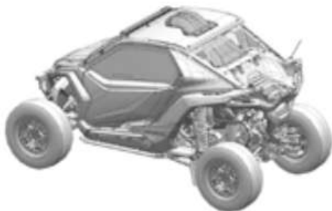
Vyobrazené príslušenstvo strechy a strešného nasávacieho nástavca pre model Z10 TURBO
